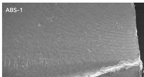
ABS-1 破断回数 450 万回（繰返応力 9.1MPa） 疲労破壊特有の貝殻模様を観察
