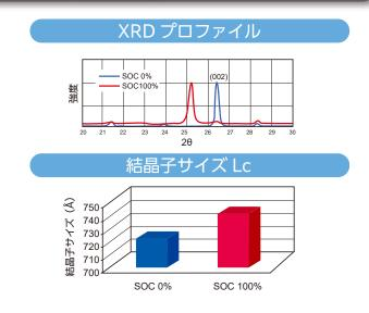
充電により正極では Li の離脱で層間の結束が弱まり、面間隔が広がった。一方、負極では Li の挿入で面間隔が広がった。正極充電時では Li の離脱の影響で結晶子サイズの低下が顕著であった。
