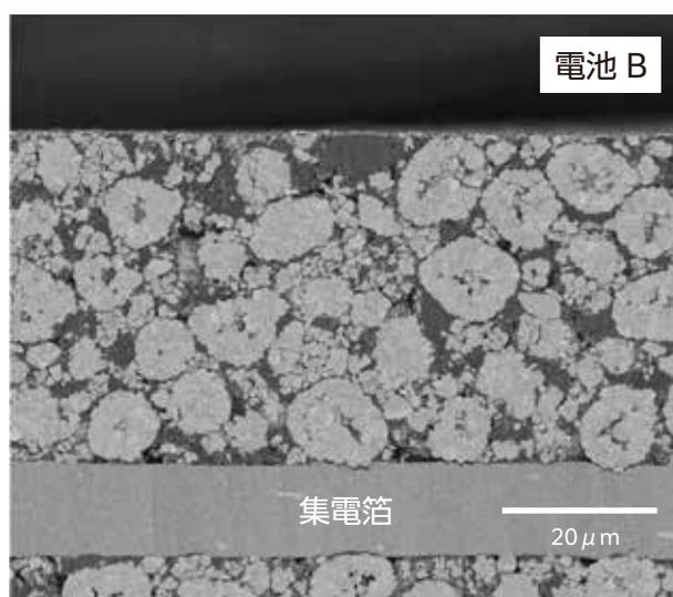
断面はイオンミリングにて作製した。元素分析した結果、電池 A では  $\text{LiCoO}_2$ 、電池 B では、 $\text{LiCo}_{1-x-y}\text{Ni}_x\text{Mn}_y\text{O}_2$  が用いられていた
