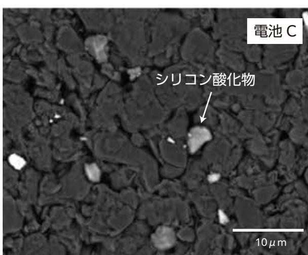
・ SEM（反射電子像）により電池 C 負極中に粒子（白色）が観察され粒子を元素分析した結果、ケイ素と酸素を検出
