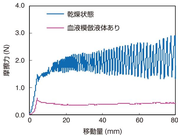
親水化処理 PET は乾燥状態ではスティックスリップ (現象) の挙動を示したが、血液模倣液体ありでは、滑り片がなめらかに動き、スティックスリップ (現象) が改善した。
