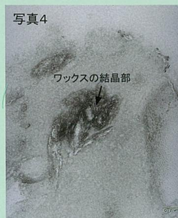
写真3中の染色したワックスを高倍率で観察すると鮮明な結晶部が見られる
