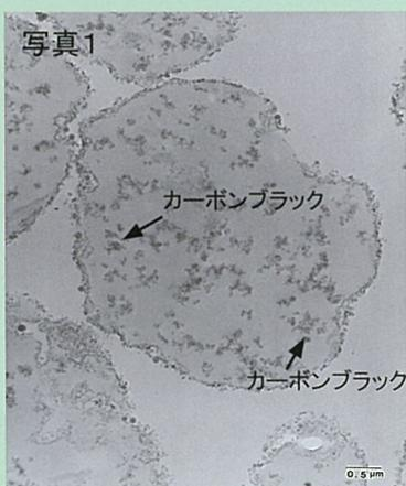
直径約 $5 \mu\text{m}$ のトナー樹脂中に約 $0.2 \mu\text{m}$ に凝集したカーボンブラックが分散している状態がわかる
