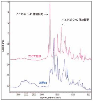
ポリアミック酸を加熱すると 1725cm-1、1366cm-1 にイミド基由来の吸収が現れる。1366cm-1 のイミド基 C-N 伸縮振動からイミド基の生成を追跡する
