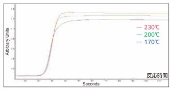
イミド化温度を変えて反応追跡した。温度により イミド化率が異なることが判る
