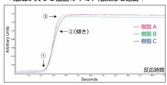
組成が異なる樹脂の反応追跡を行った 樹脂により、①イミド化開始温度、②イミド化速度、 ③イミド化率が異なる
